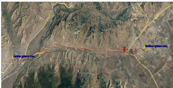
3-р зураг. Амгалан ДС-аас Налайхын ДС хүртэл дулааны шугам татах тойм зураг L-27км
